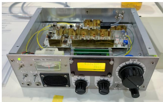
写真6,7 JG3ADQ 永井さんの430MHz FM トランシーバー
