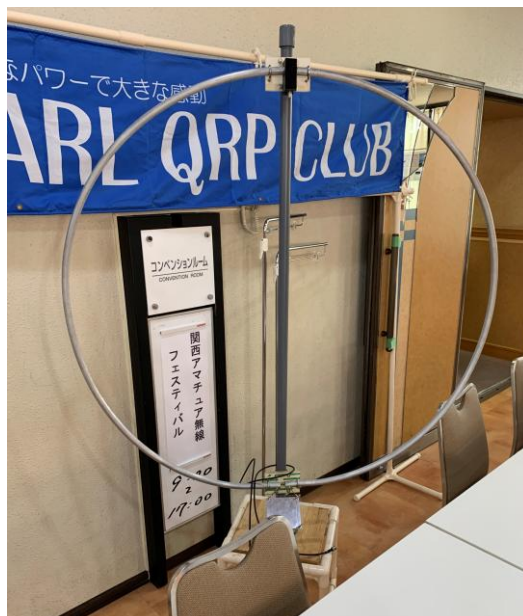
写真 12 JS1BVK 山田さんの 7MHz マグネチックループアンテナ
