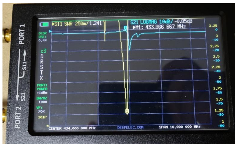
写真2 HDR433M フィルタの特性 (nanoVNA)
