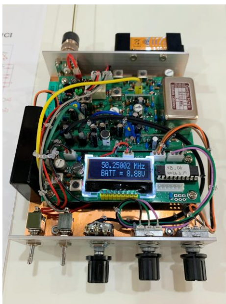
写真 9 JE1UCI 富川さんの 50MHz SSB ワンボードトランシーバ
