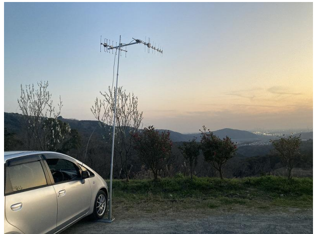
写真 1 (左) 製作記事を元に基板化した Xtal テスタと 7mm 角コイルテスタ 写真 2 (右) 製作した 430MHz 八木アンテナでの移動運用
