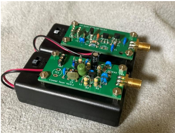
写真 1 (左) 製作記事を元に基板化した Xtal テスタと 7mm 角コイルテスタ 写真 2 (右) 製作した 430MHz 八木アンテナでの移動運用
