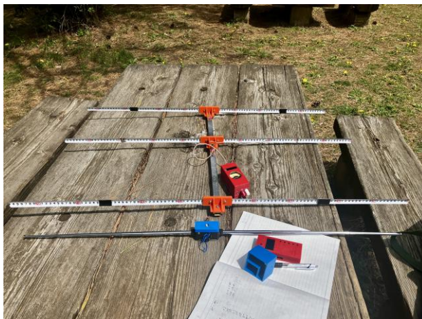
写真 5 巻尺を使った ARDF 用 145MHz 3 エレ八木アンテナ (7L4WVU 原口さん)
