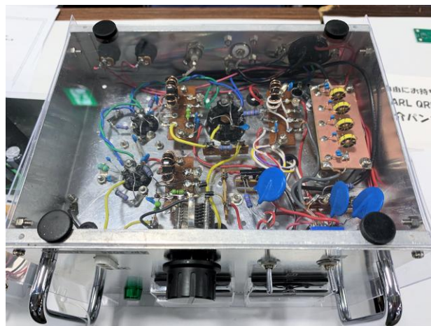
写真 7,8 真空管式 50MHz AM QRP 送信機 (JA8CXX 高野さん)
