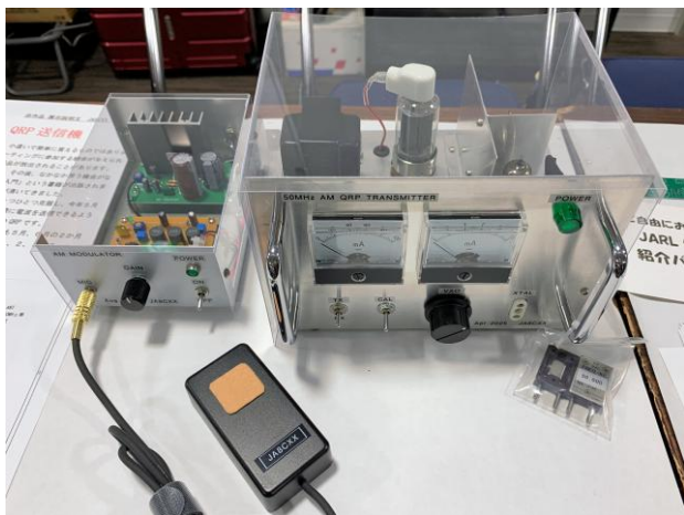
写真 7,8 真空管式 50MHz AM QRP 送信機 (JA8CXX 高野さん)
