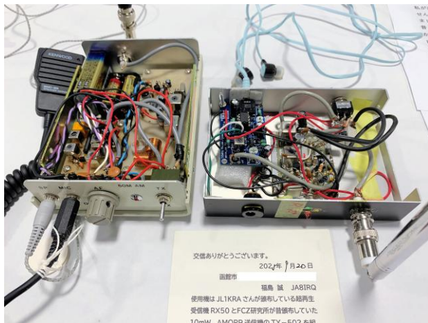
写真 19 JA8IRQ 福島さん (右) と JN3DMJ 松本 (左) の 50MHz AM トランシーバー
