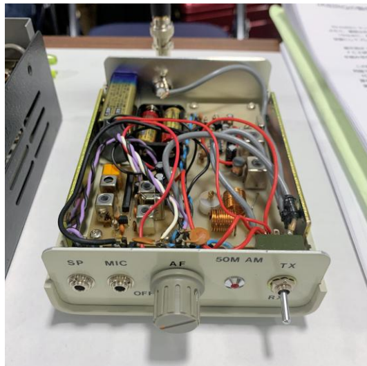
写真 18 50MHz AM トランシーバー「ミニトラ」(JN3DMJ 松本)
