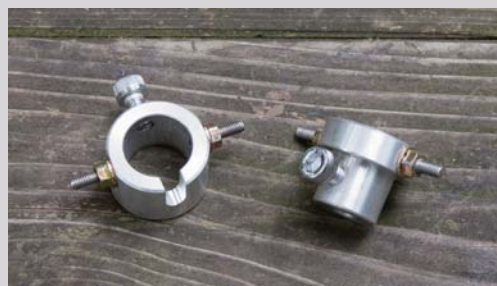
下、上のクロスマウント。切り込みや段差は収納時二つを組み合わせて小さくするため。
