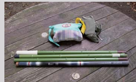
釣り竿 3.6m 分 + 園芸竹 3 本つなぎ 1.5m 計 5.1m。竿とのつなぎ部分には段がつけてありステーリングが付けられる。
