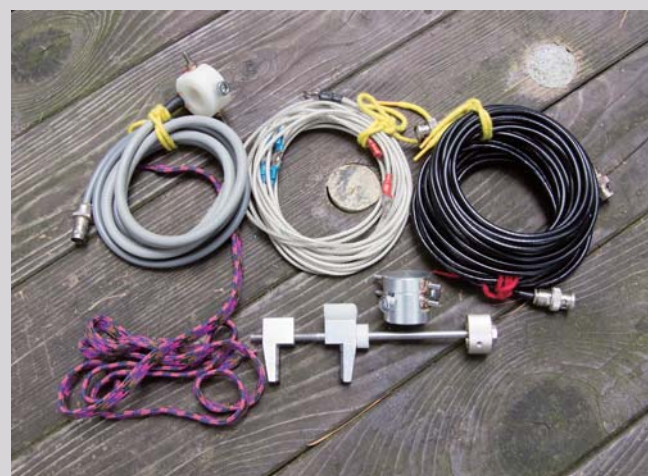
左上から、給電部（シュベルトップ）、縦エLEMENT、同軸ケーブル、マスト固定用靴紐、この運用地のテーブルに合わせて作ったマストクランプ、クロスマウント部。
