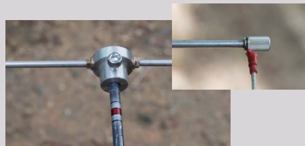
上クロスマウント部分と縦エLEMENT 接続部。
