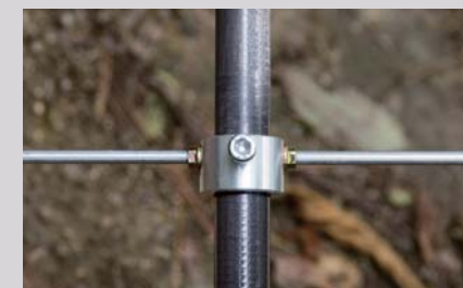
下クロスマウント部。横エLEMENT は 6mmΦ丸棒。両端に 4mmΦタップ穴を切っている。
