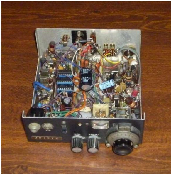
自作トランシーバ (エレキ\_内蔵,フルブレークイン,HTK フィルター使用シングルスーパー), 終段2SK19 x 1
