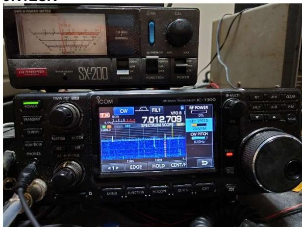
RIG : IC7300M (出力レベル 0% ≒ 1watts)
