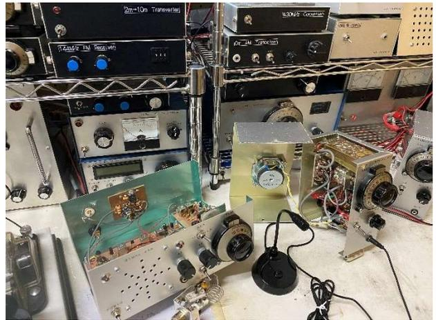
Rig: DSB TRX 21MHz 2SC2166×1 50MHz 2SC1973×1
