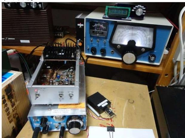
送信機: 自作トランシーバ+自作トランスバータ 終段 VMP4 出力 5W
