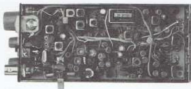
写真5 専用のSSBフィルターがはいった現在の形のもの、フィルターには“Pico-Tra”の文字がある
