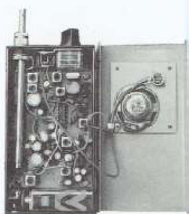
写真2 ミズホ通信にある50MHz DSB機の中 身。まだ立派に動作する
