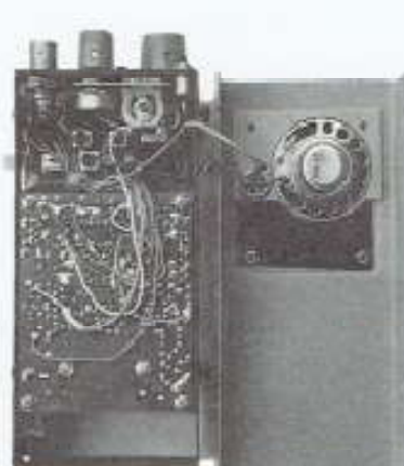
写真3 初代のビコ。基板は上下に分かれ、電池 も006P仕様になっている
