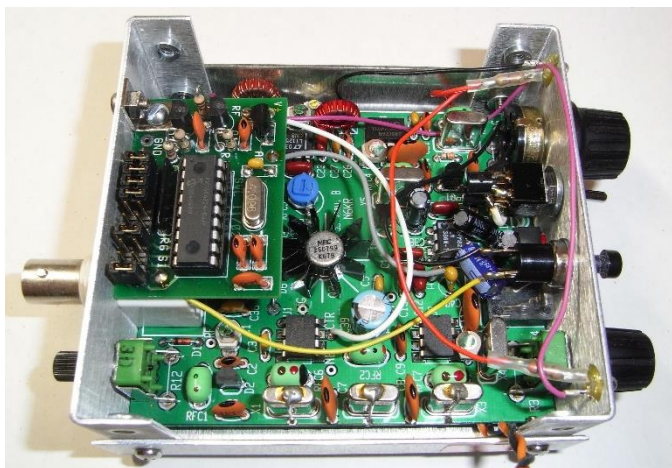
JO1EEQ 3.5MHz の QRP はきついかと思いましたが、 どうか交信できました。7MHz TX は JF1RNR 今井 栄氏設計の回路を FCZ 基板で作りました。TX: 2SK241、RX: K-1(エレクラフト,キット)
